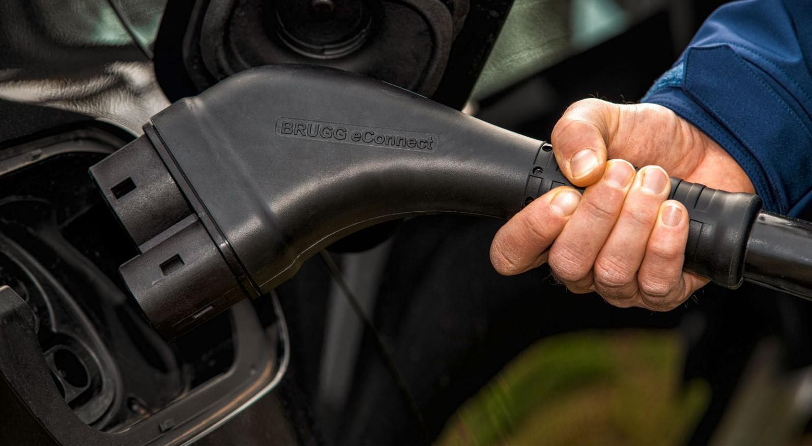
Mit Schnellladesystemen der BRUGG eConnect können E-Autos in 8 bis 12 Minuten geladen werden (80%).
