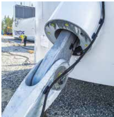
TRUpin – permanente Messung und Überwachung der Seilkraft.
