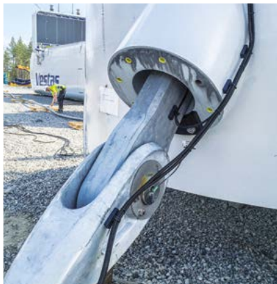
TRUpin – permanente Messung und Überwachung der Seilkraft.
